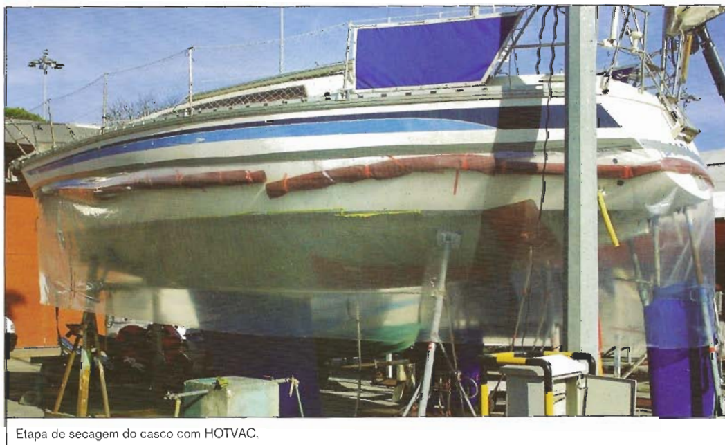
Figura 5: Secagem com aquecimento e vácuo com um equipamento HOTVAC. Com vácuo da ordem de 10% da pressão atmosférica, mesmo os compostos de ponto de ebulição mais levados (ca. 200°C) fervem a menos de 90°C (temperatura recomendada para a secagem), conseguindo-se secar totalmente uma área de 1 m 2 em menos de 8-12 h. ( www.hotvac.com )
