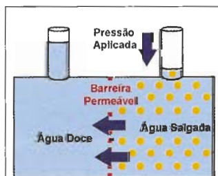
Figura 1b: O princípio da Osmose Inversa implementado nas unidades de dessalinização de água do mar.
