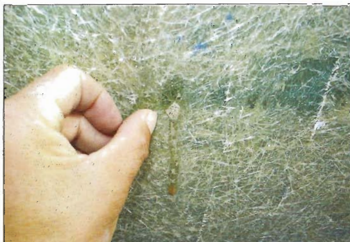
Figura 3: Wicking: canais vazios de resina entre fibras que podem absorver água por capilaridade com grande velocidade (resultante de uma fabricação deficiente, típico em laminados anteriores a 1990-1995). (adaptado de T. Staton-Bevan, "Osmosis and Glassfibre Yacht Construction", 2nd Ed Sheridan House (1995).
