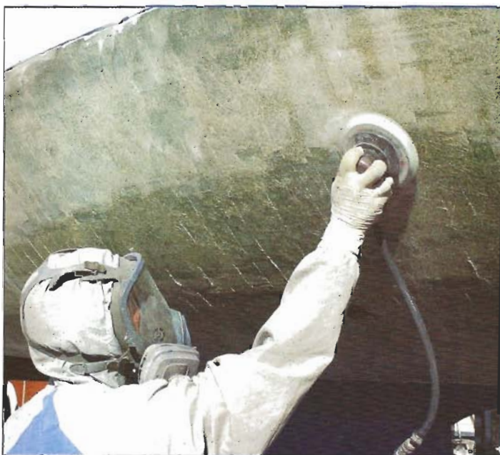
Regularização da superfície do casco após remoção do gelcoat (cortesia Tecniates).
